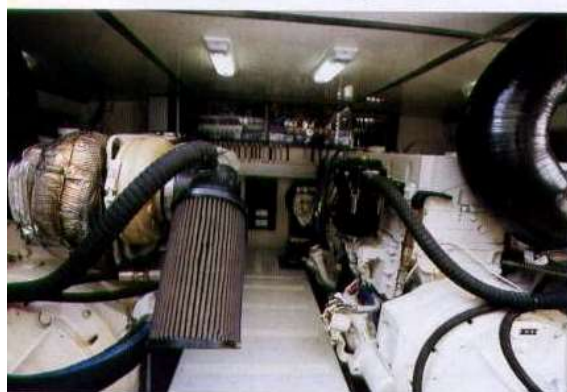
La spaziosa cala motori ospita due entrobordo Cummins da 670 cavalli.
