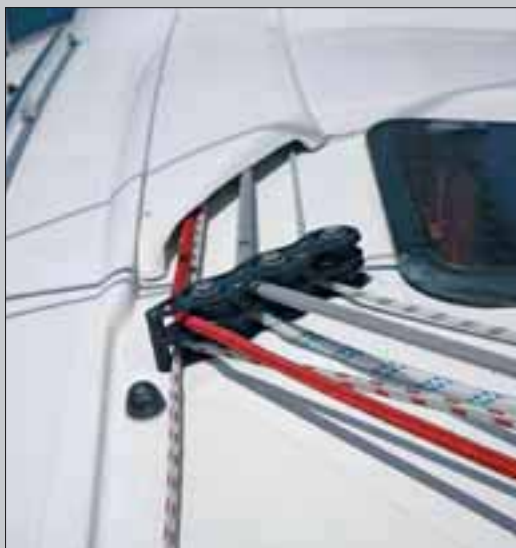
Sotto e di lato, tutte le manovre sono rinviate in pozzetto per raggiungere il quale corrono sotto una calandatura facilmente smontabile
