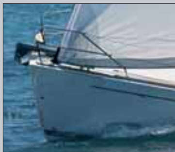
Di lato, il profondo gavone delle ancore. Sotto, il musone corto porta l'ancora a poggiarsi alla prua e danneggiarla durante la navigazione con mare formato
