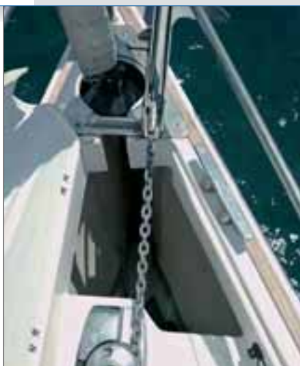
Sotto e di lato, tutte le manovre sono rinviate in pozzetto per raggiungere il quale corrono sotto una calandatura facilmente smontabile
