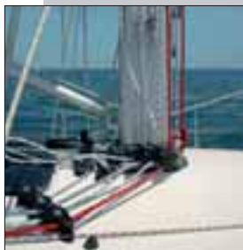
Sotto e di lato, tutte le manovre sono rinviate in pozzetto per raggiungere il quale corrono sotto una calandatura facilmente smontabile
