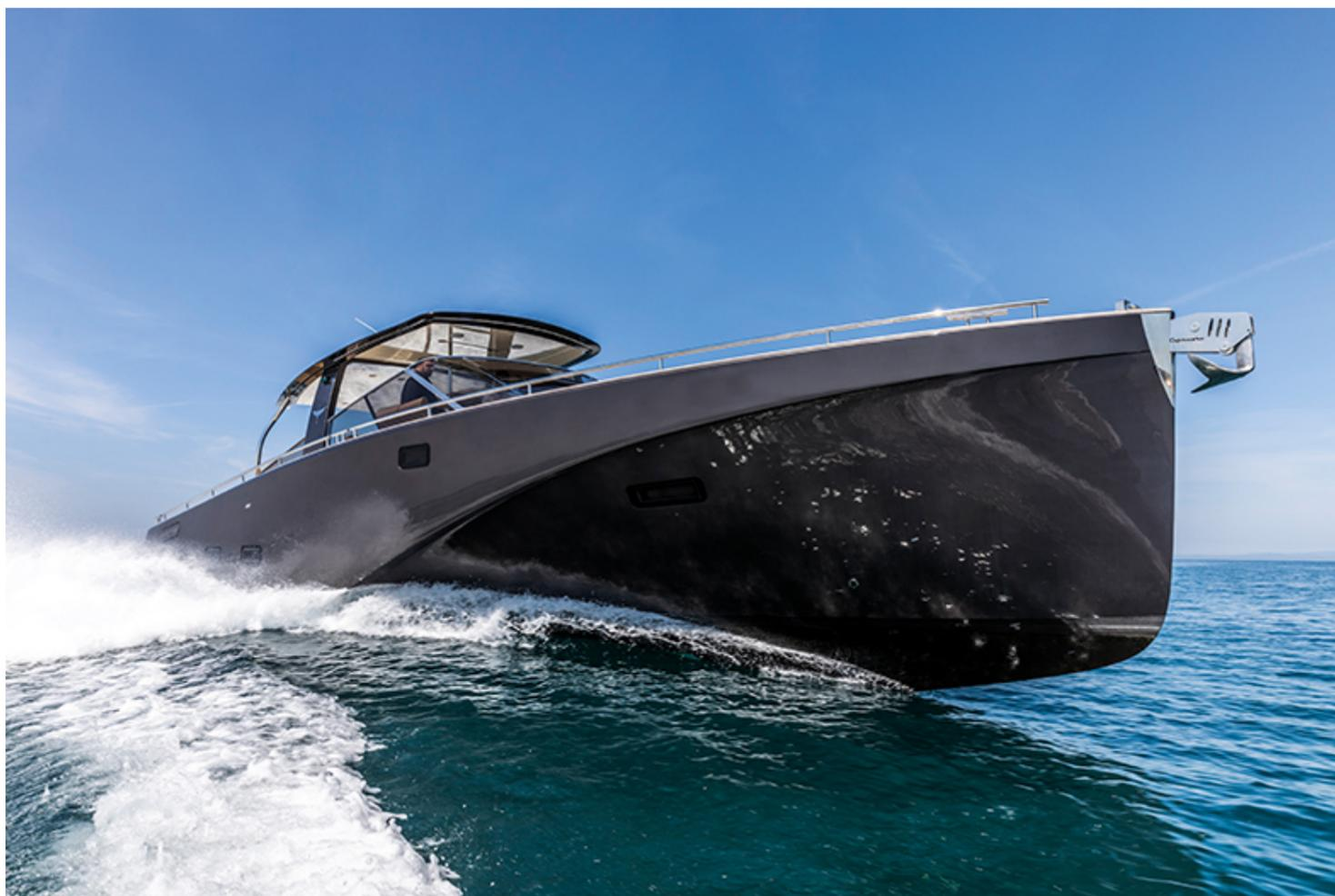
**Heron 56 è un motoryacht dalle forme inconsuete, primo esemplare del cantiere fondato da Roberto Bello. La nostra prova ha messo in luce ottime caratteristiche di navigazione con consumi contenuti. Con due Volvo Penta Ips 600 abbiamo superato 26 nodi di velocità**
