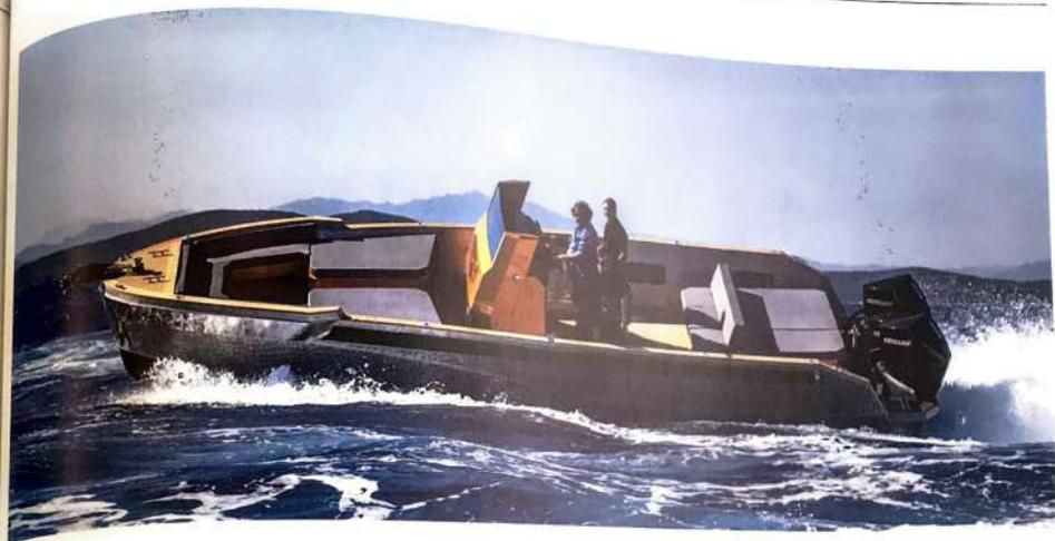
La carena a V profonda garantisce un assetto ottimale in ogni condizione di mare anche alle elevate velocità. Nella versione più spinta l'Heritage tocca i 57 nodi.
