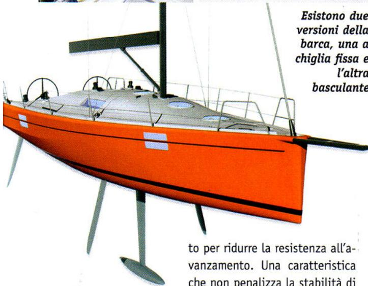
to per ridurre la resistenza all'avanzamento. Una caratteristica che non penalizza la stabilità di forma grazie a uscite poppiere a spigolo che garantiscono inoltre buona stabilità di rotta alle andature portanti e una grande facilità a entrare in surf.
