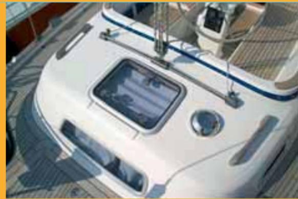
*In alto, la tuga sopra la cabina di poppa con il suo passauomo e l'areatore per garantire il cambio d'aria a barca chiusa. Di lato, un passavanti con il tintibene in teak*
