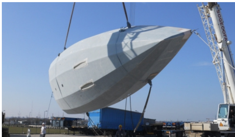
Un'immagine della carena stellata dell'RM 1260, da notare la parte centrale piatta
