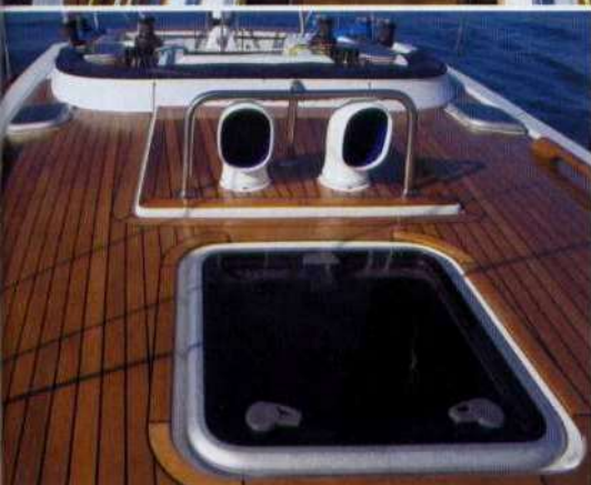
Sopra, le due maniche a vento Dorade e il boccaporto centrale montato a filo del teak. A destra, uno dei due capienti gavoni ricavati in pozzetto. Eccessiva la potenza del pistone che sostiene il portello.
