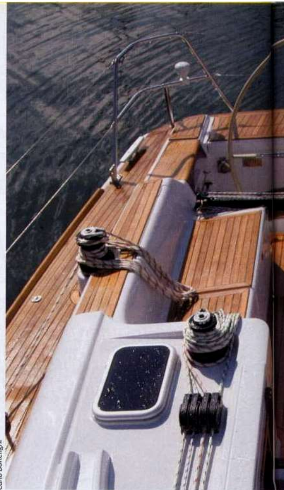
Sotto, le drizze corrono nascoste sotto la calandra in vetroresina smontabile, a vantaggio della pulizia della tuga.
