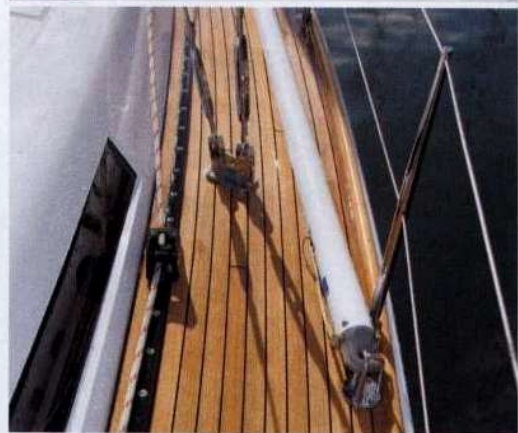
Sopra, le lande interne consentono di armare un genoa con Lpg superiore al 100%; il ponte in teak è opzionale, mentre la falchetta, sempre in teak, è fornita di serie. I passavanti sono larghi oltre 50 cm a centro barca.
