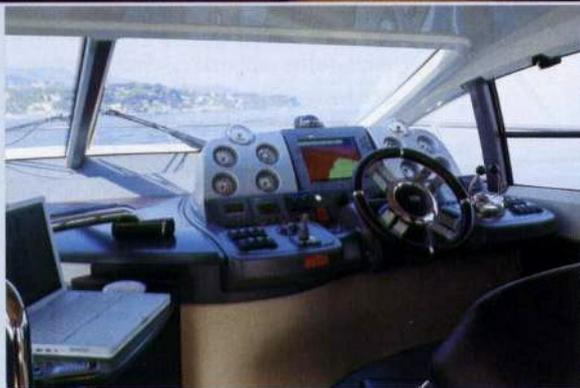
*Sopra, la timoneria prevede la guida da seduti su un divano a due posti con schienale reclinabile. La plancia è organizzata su misura per le strumentazioni digitali dei motori e per il Gps-plotter di navigazione con schermo da 12".*
