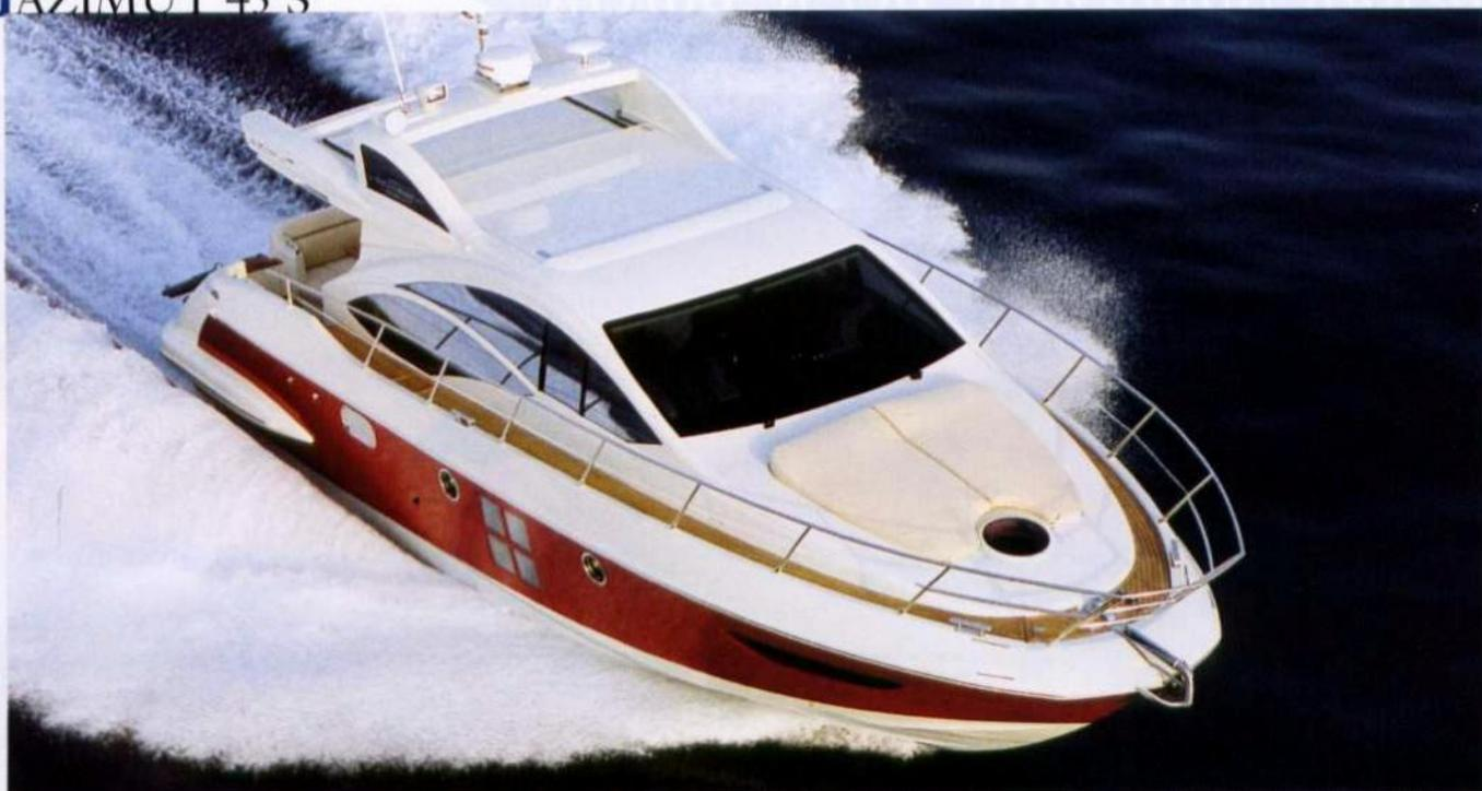
Sopra, l'Azimut 43 S a tutta velocità, con lo scafo immerso per tutta la sua lunghezza, in modo da offrire un buon comfort anche sul mosso. L'imbarcazione sorprende per l'agilità e la precisione in virata, merito della trasmissione Volvo IPS.
