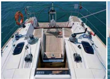
Sopra, il pozzetto lungo 156 centimetri dispone di panche in grado di offrire una comoda seduta a sei persone. A destra, la posizione del timoniere è risultata ergonomica e permette una buona visuale
