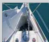
A sinistra, il pozzo dell'ancora può contare su una buona profondità per il rimessaggio della catena. Sotto a lato, la tuga allungata si raccorda bene al piano di coperta. Gli oblò presenti su di essa garantiscono una discreta luce agli interni. Sotto, i passavanti misurano 40 centimetri nel punto più largo e hanno qualche intralcio all'altezza delle lande
