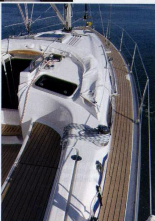
Sopra, l'accesso al pozzo catena è ostacolato dalla sede del salpancora.
