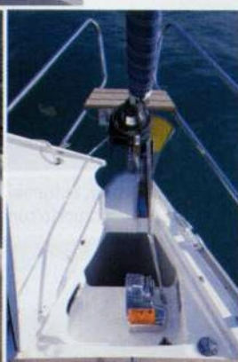
Sopra, l'accesso al pozzo catena è ostacolato dalla sede del salpancora.
