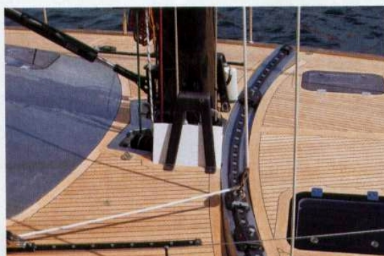
Sopra, l'ampio pozzetto caratterizzato dalla doppia ruota con le manovre sulle colonnine. Sotto, la rotaia del fiocchetto autovirante. Si nota anche il canard a regolazione idraulica.
