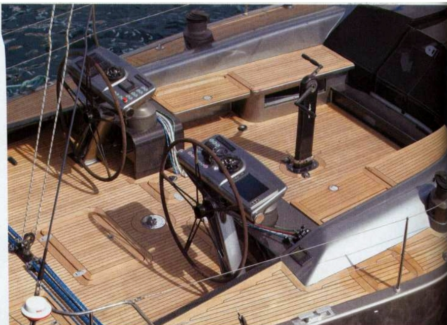
Sopra, l'ampio pozzetto caratterizzato dalla doppia ruota con le manovre sulle colonnine. Sotto, la rotaia del fiocchetto autovirante. Si nota anche il canard a regolazione idraulica.
