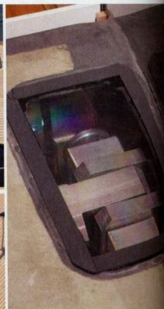
Sopra, il perno su cui ruota la canting keel. A sinistra, la tuga corta ha un design moderno che ben si raccorda alla coperta.
