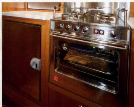
A sinistra, la cucina basculante fornita di quattro fuochi è di facile utilizzo anche in navigazione con barca sbandata. Sotto, la dinette, ben illuminata dalla finestratura presente sulla tuga, è dotata di due comodi divani e tavolo che ruota elettricamente.
