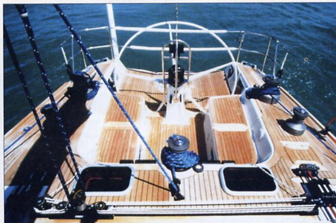
*A sinistra, la versione con pozzetto di poppa a ruota singola. Le drizze corrono incassate nella tuga ed escono, come visibile nella foto, davanti ai winch laterali.*
