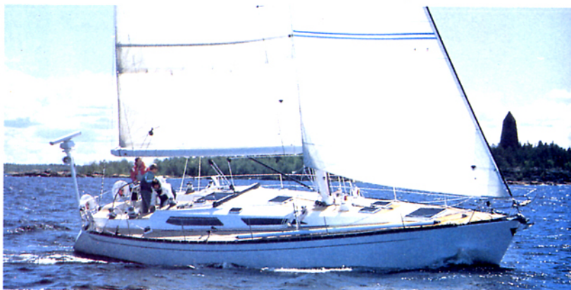
Il Baltic 47 che abbiamo provato era il primo esemplare varato. Durante la prova abbiamo constatato le potenzialità di questo progetto di Judele/Vrolijk con venti leggeri dove può sfruttare l'alto sviluppo del piano velico che armato in testa d'albero risulta per altro di facile regolazione e molto sicuro.
