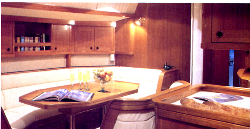
La dinette è in grado di ospitare otto persone, comodamente sedute intorno al tavolo ottagonale. Per aumentare la larghezza del corridoio, il divanetto scorre su due rotaie fino a ridosso del tavolo; in condizioni di barca sbandata, in assenza di un tientibene, risulta però un prezioso punto d'appoggio.
