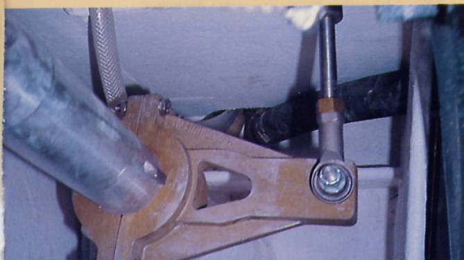
Il collegamento rigido tra la ruota e l'asse del timone consente di avere sempre il massimo della sensibilità.
