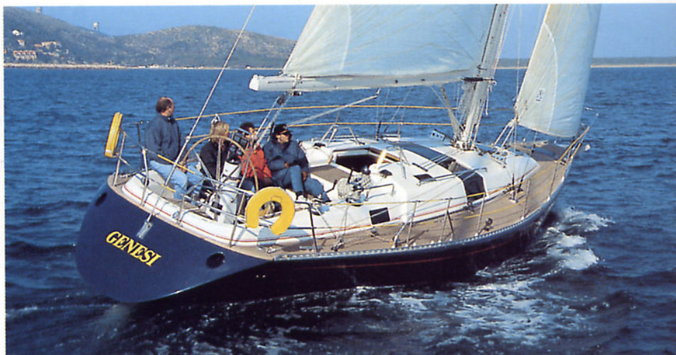
Il Genesi della Comar nella versione crociera in navigazione. Nella nostra prova abbiamo apprezzato la pregevole stabilità di rotta anche sotto spi. La ruota è risultata anche eccessivamente demoltiplicata, ma il cantiere ci ha detto che verrà maggiorato il pignone della colonnina.
