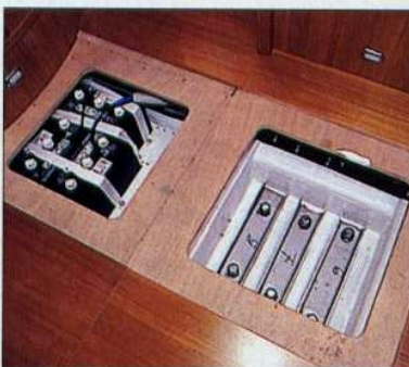
A destra, l'ampio e ben rifinito bagno armatoriale dotato di tutti i comfort. Sopra, alzando il pagliolato della dinette si possono notare i madieri del bulbo e un vano per le batterie dei servizi.
