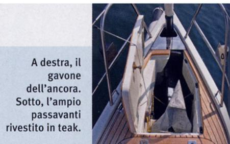
A destra, il gavone dell'ancora. Sotto, l'ampio passavanti rivestito in teak.
