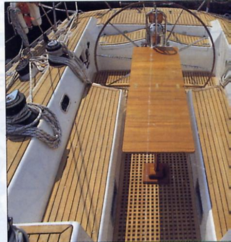
*Le panche del pozzetto misurano 2,50 m., il grande tavolo è incernierato sulla colonnina del timone. Il passaggio a lato della ruota non è dei più agevoli.*
