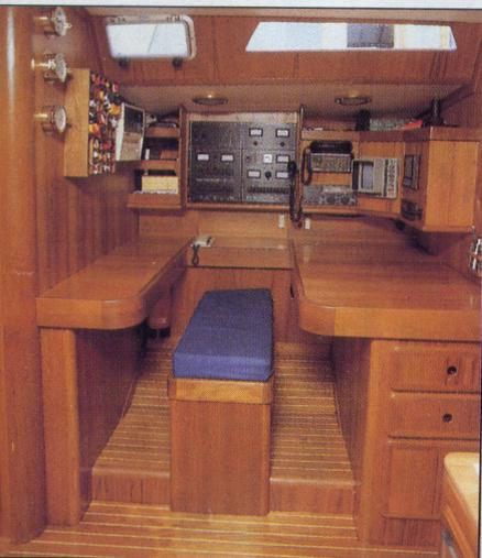
*La zona carteggio con lo spazio per la strumentazione, sotto il sedile si trova uno dei due banchi di batterie servizi.*
