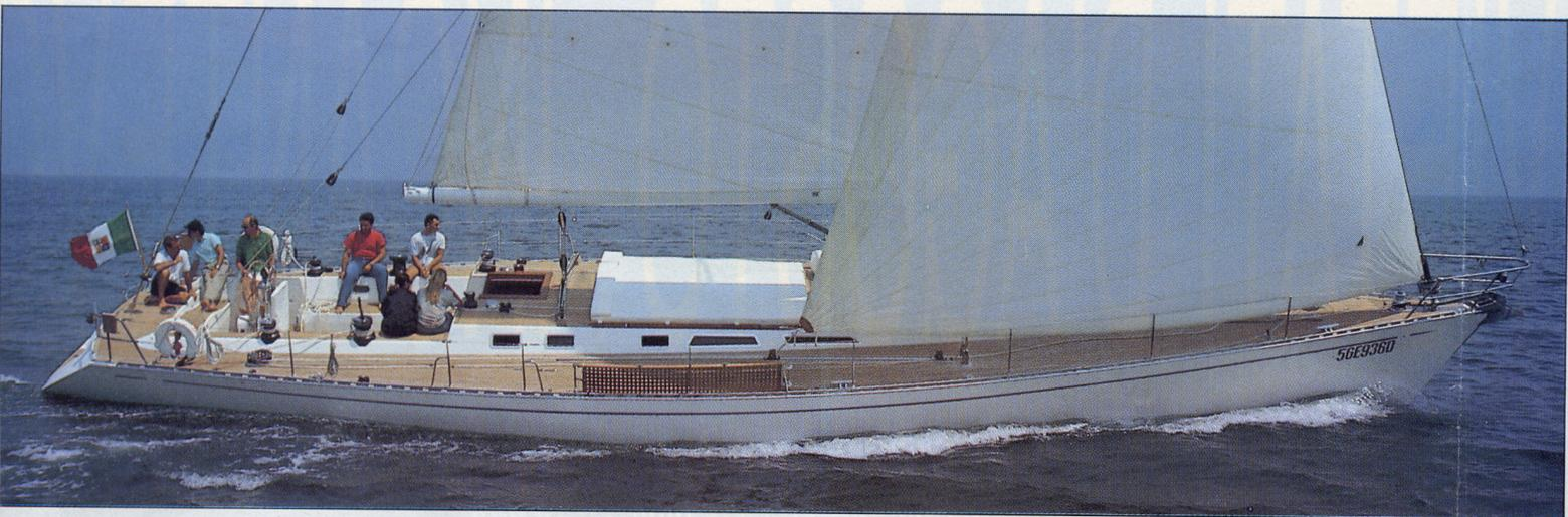
*Non appena si poggia, gli Uldb esprimono un passo potente con spunti di velocità sorprendenti. Le due vele di prua rollabili rappresentano un tipo di armamento molto efficace con equipaggio ridotto, usato con successo anche sui monoscafi partecipanti al B.O.C.: al rinforzare del vento si chiude il genoa e si apre la trinchetta.*
