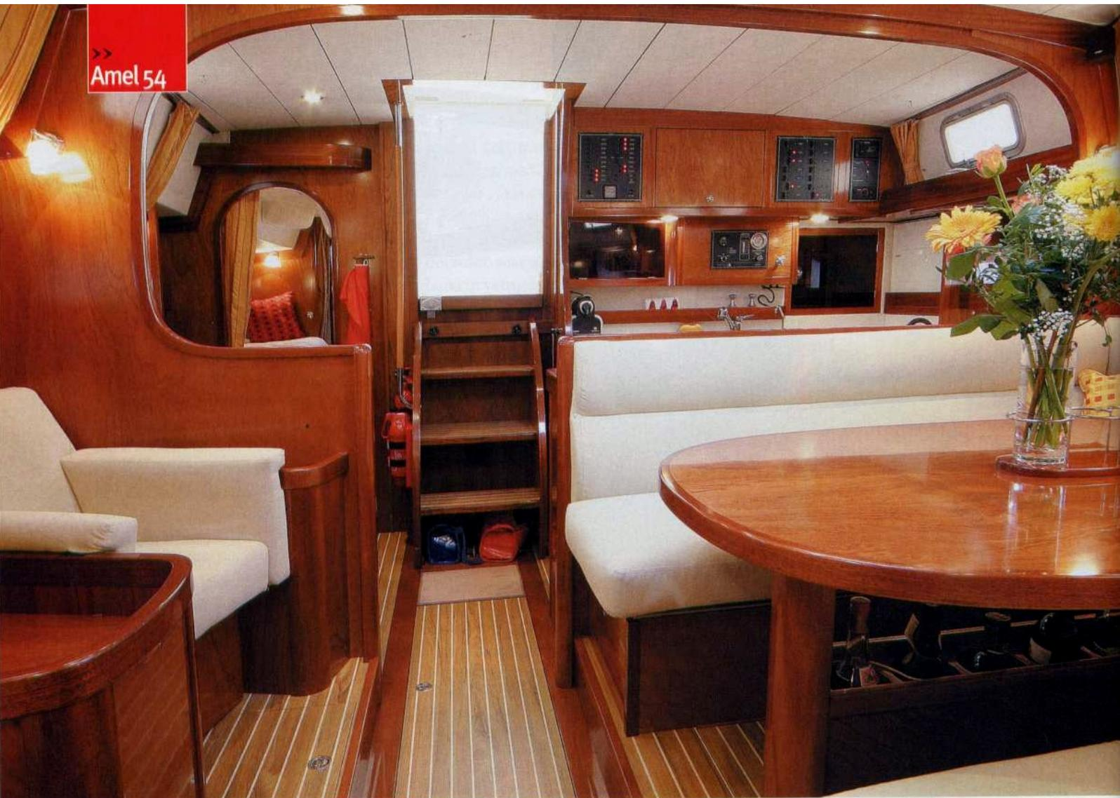
Sopra, il quadrato visto da prua. Da notare il corridoio ribassato rispetto al piano delle due zone living contrapposte. Sotto, le due cabine di prua, separabili con la paratia a pannelli scorrevoli visibile nella foto.
