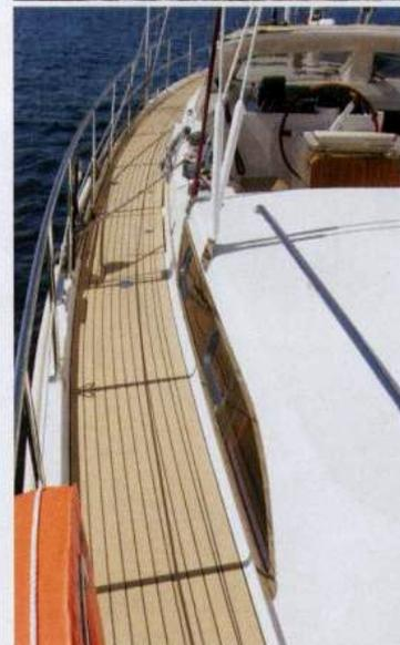
A sinistra, i passavanti sono larghi e liberi da intralci. Sia le rotaie del genoa, con regolazione a circuito chiuso del carrello, sia le lande sono a murata. La battagliola alta 75 cm è realizzata con tubolare di acciaio inox.
