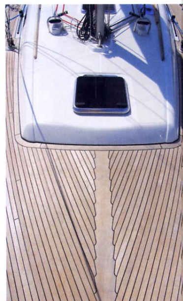
Sopra, la tuga si interrompe con un taglio netto un metro a prua dell'albero, lasciando un'ampia superficie libera utilizzabile come prendisole.
