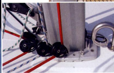
Sopra, il piede d'albero che poggia in coperta con il collo di cigno per il passaggio dei cavi elettrici. A sinistra, uno dei due boccaporti delle cabine di poppa.
