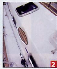
**2:** per l'accesso al pozzetto, che in presenza di paraspruzzi larghi come quelli del Beneteau 50 è sempre difficoltoso, è stato realizzato un gradino rivestito in teak sul fianco della tuga.
