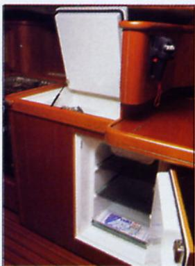
In cucina sono previsti un frigo a pozzetto con compressore collegato al motore e un frigo elettrico ad apertura verticale.
