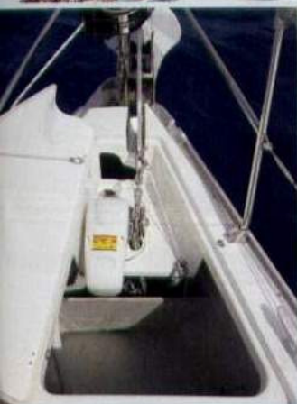
A sinistra, il gavone dell'ancora è profondo e fornito di salpancora ad asse orizzontale.
