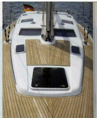
Sopra, la tuga vista da prua mette in evidenza l'ampia finestratura presente su di essa. Si nota anche il prendisole ubicato a prua dell'albero. A lato, il passavanti ha misure limitate soprattutto nella parte adiacente al paramare del pozzetto.
