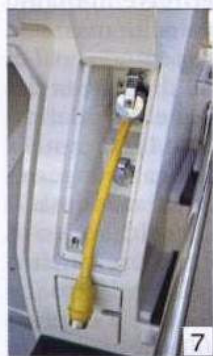
7. Sullo specchio di poppa sono installate le prese di corrente per la banchina.
