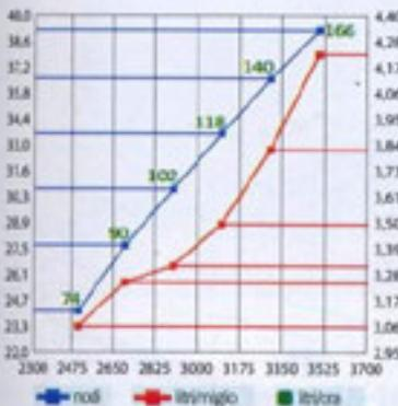
I consumi indicati nel grafico sono stati rilevati dal cantiere sul computer di bordo, ma il consumo reale potrà discostarsi dai dati pubblicati in funzione del carico imbarcato e della sua posizione, delle condizioni di uso dell'unità, della messa a punto e dello stato dei motori stessi, oltre che dalle caratteristiche delle eliche utilizzate, condizioni di uso dell'unità, della messa a punto e dello stato dei motori stessi, oltre che dalle caratteristiche.
