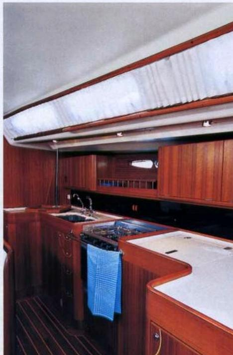
Ventilazione: buona, grazie a due oblò apribili di cm 70x25 e un oblò apribile di cm 40x15 - Illuminazione naturale: buona, grazie ai tre oblò - Illuminazione artificiale: buona, tre plafoniere alogene - Sicurezza: buona - Rumorosità motore in navigazione: 68 dBA.
